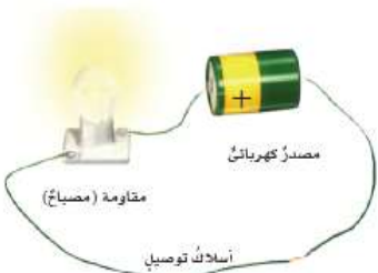
▲ أجزاء الدائرة الكهربائية.
